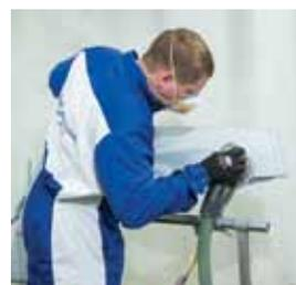
Для теста мы подготовили одну стандартную метровую панель, места повреждений которой были тщательно зашпатлеваны. Целесообразнее сразу качественно выполнить «грубые» работы, нежели позднее выравнять поверхность обильным слоем дорогого грунта.
