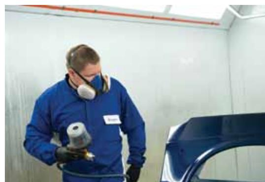
нескольких панелей. Существует две пропорции смешивания. Первая - 5 – 1 – 1, предназначена для точечного локального ремонта и окраски 1-3 деталей. Вторая пропорция - 4 – 1 – 1 подходит для многопанельного ремонта и водоразбавляемого базового покрытия. В нашем исследовании мы использовали последнюю пропорцию, смешав четыре части лака с одной частью отвердителя 1080 (который применяется для полимеризации грунта) и 1 частью стандартного разбавителя АТХ.
