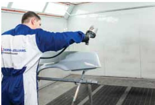
В тесте для нанесения использовался краскопульт DeVilbiss PRI Pro, с дюзой 1,4 и воздушной головкой P1, давление нанесения 2 бара. Выдержка между слоями при температуре 25 °C составила всего 60 секунд. Сергей Саватеев уточняет, что при летнем зное этот интервал сократится до 30 секунд. Для сравнения, про-
